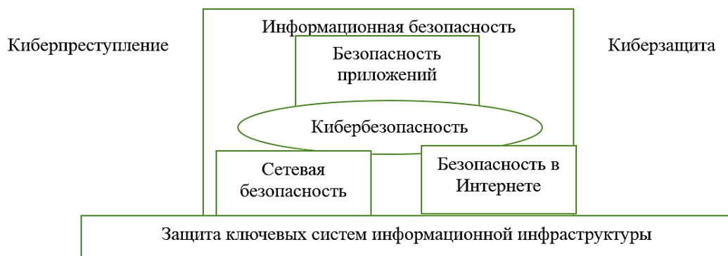
Рисунок 1. Взаимосвязь кибербезопасности с другими видами безопасности в соответствии со стандартом ISO/IEC 27032:2012
